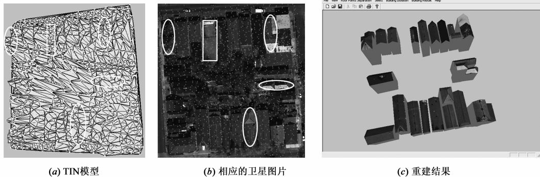
图8 建筑物重建示例2
